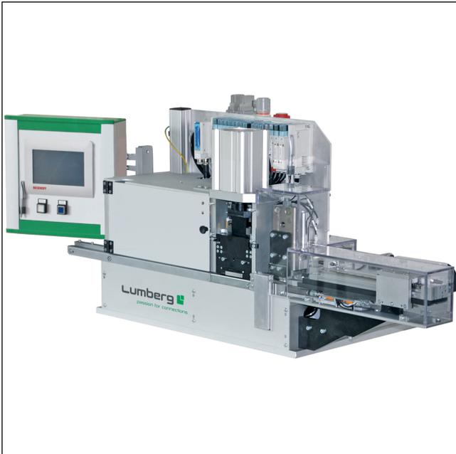
Halbautomatische Verarbeitungsmaschine für das Anschlagen von RAST-2.5-Steckverbindern in Schneidklemmtechnik (SKT), größere Basismaschine, mit integrierter Station für das Entfernen der Verkettungsstege, individuell nachrüstbar
