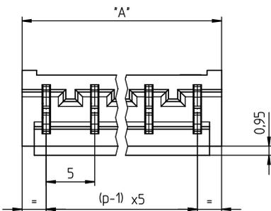
\*a Lötstift für Leiterplattenbohrung  $\varnothing$  1,3 mm
