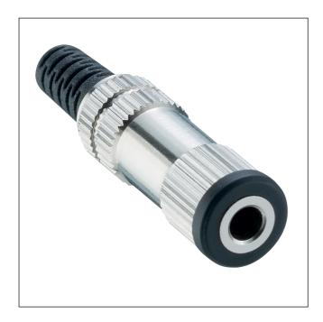
Klinkenkupplung nach JIS C 6560 JC35J2A, 3,5 mm, 2-polig/mono, gerade Ausführung, mit Metallgehäuse, Knickschutz und Lötanschlüssen
