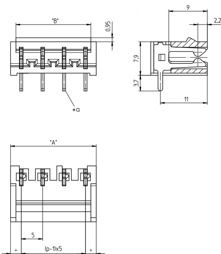
\*a Lötstift für Leiterplattenbohrung Ø 1,3 mm
