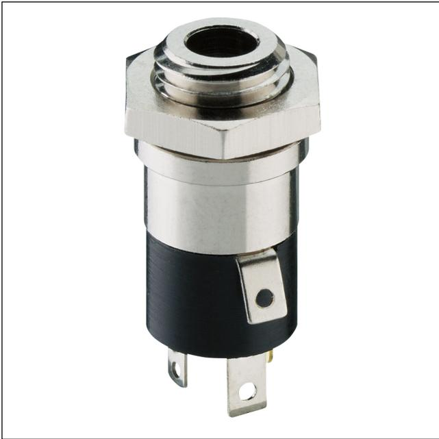
Klinkeneinbaukupplung nach JEITA RC-5325A JC35C4A, 3,5 mm, 4-polig/stereo, stehende Ausführung, mit Lötäugen, für Rückseitenmontage
