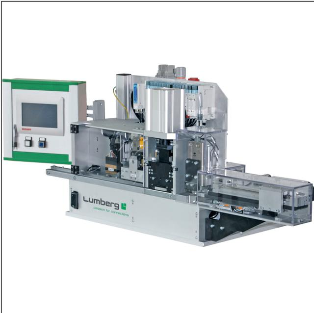
Halbautomatische Verarbeitungsmaschine für das Anschlagen von RAST-2.5-Power-Steckverbindern in Schneidklemmtechnik (SKT), größere Basismaschine, mit integrierten Stationen für Leiterfarbprüfung, Kodierschneiden und Kodierprüfen, individuell nachrüstbar
