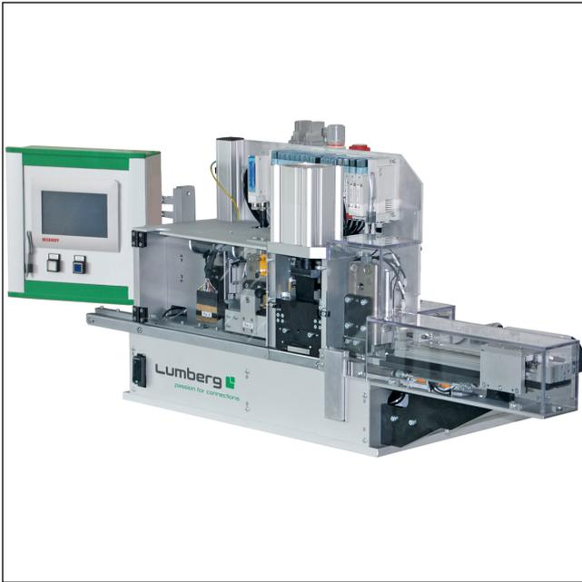
Halbautomatische Verarbeitungsmaschine für das Anschlagen von RAST-2.5-Steckverbindern in Schneidklemmtechnik (SKT), größere Basismaschine, mit integrierten Stationen für das Entfernen der Verkettungsstege, Leiterfarbprüfung, Kodierschneiden und Kodierprüfen, individuell nachrüstbar
