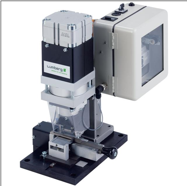
Elektropneumatische Verarbeitungsmaschine für das Anschlagen von Micromodul™-Steckverbindern in Schneidklemmtechnik (SKT)
