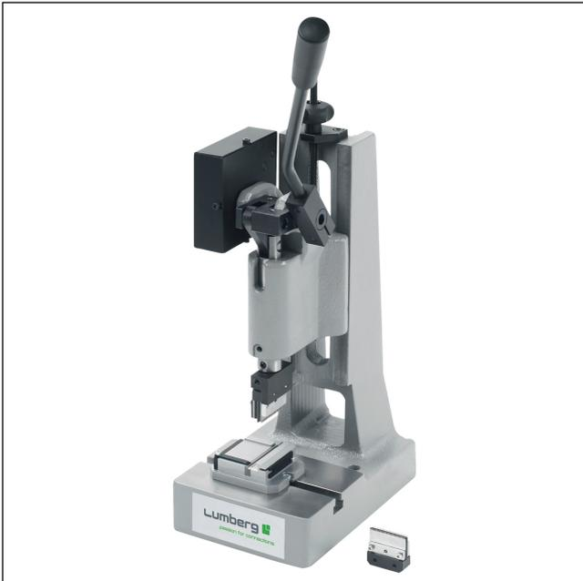
Kniehebelpresse für das Anschlagen von Micromodul™-
