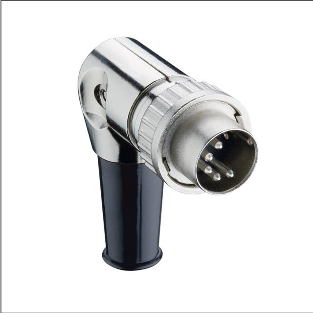
DIN-Stecker mit Bajonettverschluss, abgewinkelte Ausführung, Kontakteinsatz 0°, 90°, 180° und 270° montierbar, geschirmt, mit Metallgehäuse, Knickschutz und Lötanschlüssen
