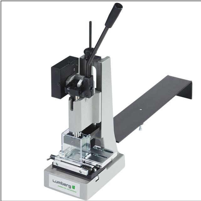
Kniehebelpresse für das Anschlagen von RAST-5-Steckverbindern in Schneidklemmtechnik (SKT)
